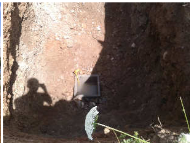
T1 - Escavazione trincea esplorativa e prova di permeabilità
