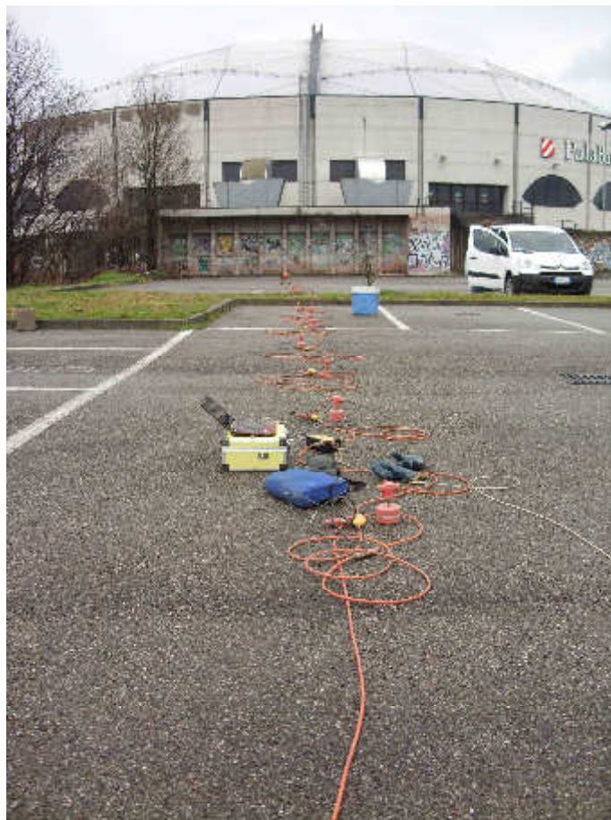
Vista dello stendimento MASW effettuato
