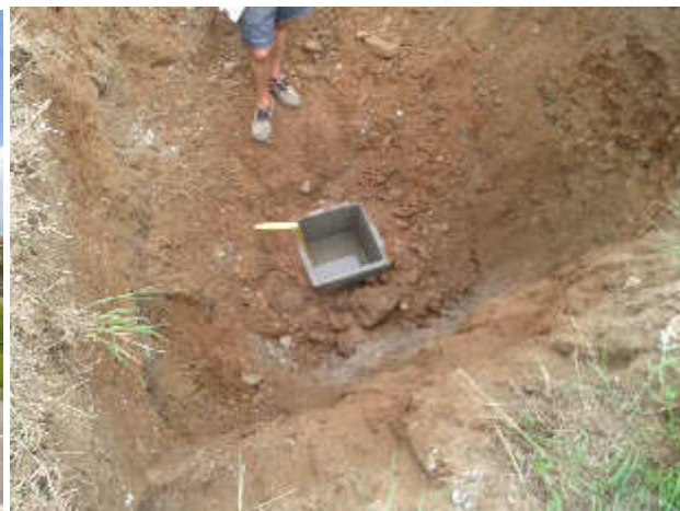
T2 - Escavazione trincea esplorativa e prova di permeabilità
