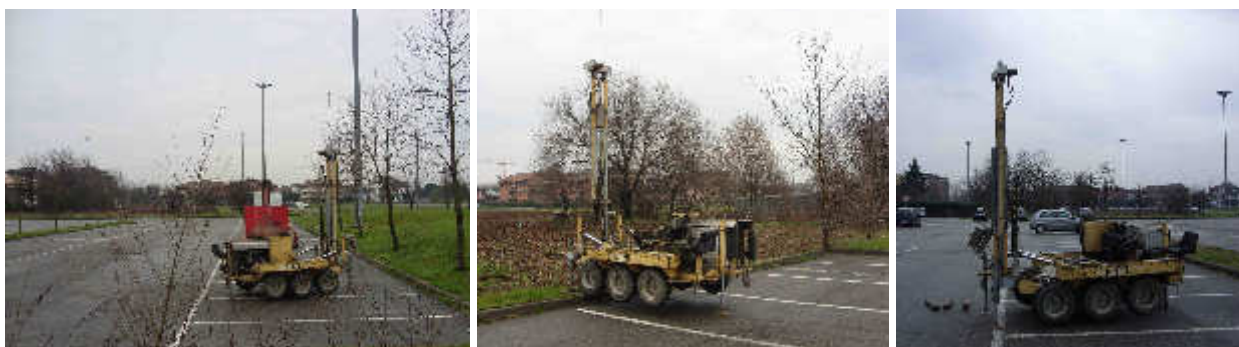
Penetrometro Super Pesante tipo Meardi A.G.I. utilizzato
